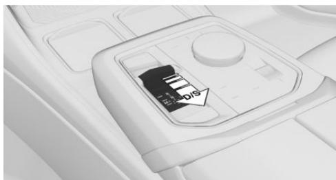
В режиме Drive нажмите рычаг селектора в направлении D/S.
