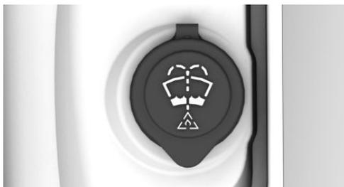
Бачок для омывающей жидкости находится в моторном отсеке.
