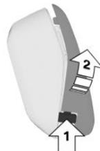
2. Движением в сторону вытяните корпус батарейки из автомобильного ключа.
