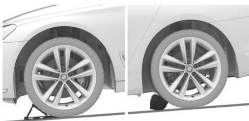
Если смена колеса выполняется на поверхности с небольшим уклоном, установите подкладные клинья или другие подходящие предметы, например камни, под колеса переднего и заднего мостов против направления качения.
