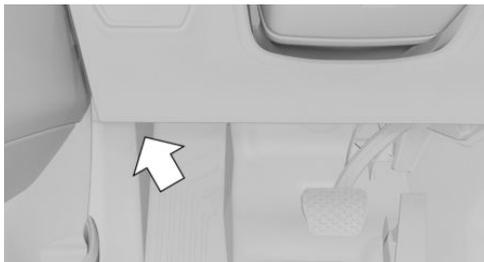
На стороне водителя находится диагностический разъем для считывания данных транспортного средства.
