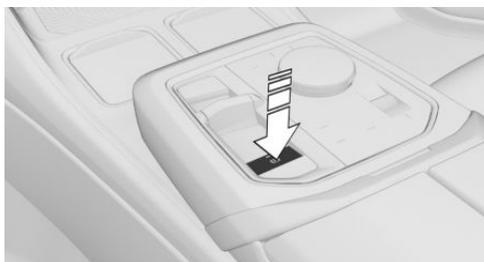
**(P)** Нажмите кнопку. Активируется парковочный тормоз, срабатывает блокировка коробки передач.
