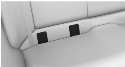
Крепления для нижних фиксаторов находятся за обозначенными накладками. Чтобы освободить фиксаторы, откройте крышки движением вверх.
