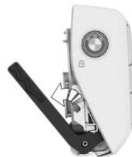
3. Извлеките интегрированный ключ из автомобильного ключа.
