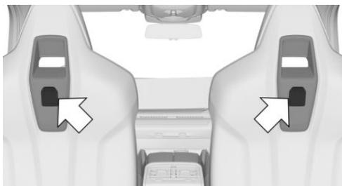
Крепления для фиксации специальных принадлежностей и разъемы USB расположены под обозначенными кожухами.
