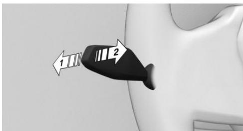
Нажмите рычаг указателя поворота вперед, стрелка 1, или с включенным дальним светом потяните рычаг указателя поворота назад, стрелка 2.
