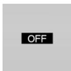
На панели приборов отображается OFF. Готовность к движению выключена, готовность к эксплуатации включена.
