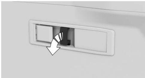
Откиньте многофункциональный крюк так, чтобы он защелкнулся со слышимым щелчком в нижнем положении.
