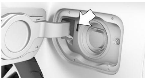
Состояние зарядки отображается на контрольной лампе высоковольтного разъема для зарядки.
