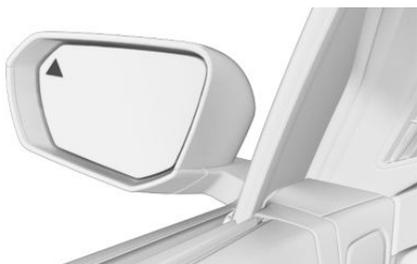
Сигнальная лампа в наружном зеркале предупреждает о возможном столкновении с распознанным автомобилем.
