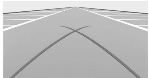
Траектории движения колес при повороте могут выводиться на изображение с видеокamеры только вместе с траекториями движения колес по прямой.
