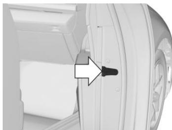
Боковой дверной замок для ручной блокировки дверей.
