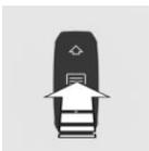
Нажмите выключатель вверх. Солнцезащитная шторка перемещается в определенное положение для частичного затенения.
