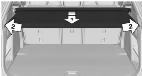
Вытяните откидную шторку багажника, см. стрелку 1, и с обеих сторон вставьте в крепления, см. стрелки 2.
