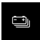
Если отображается этот символ, то электропривод недоступен из-за слишком низкой или высокой температуры высоковольтной батареи. При определенных
