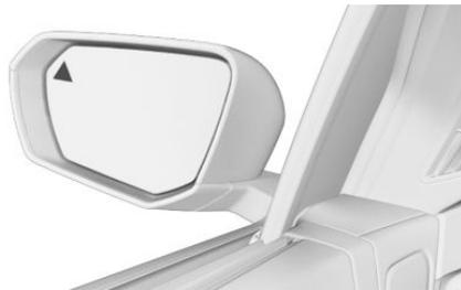
Сигнальная лампа в наружном зеркале мигает, когда задние датчики распознают автомобили, а собственный автомобиль движется назад.
