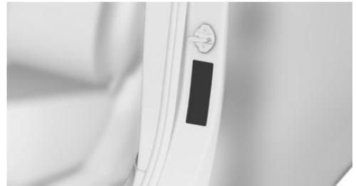
Значения давления воздуха в шинах указаны в табличке на стойке двери водителя.
