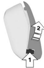
2. Извлеките интегрированный ключ с открытой стороны автомобильного ключа.
