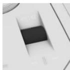
Нажмите регулятор громкости на центральной консоли. Дисплей управления и комбинация приборов загорятся.
