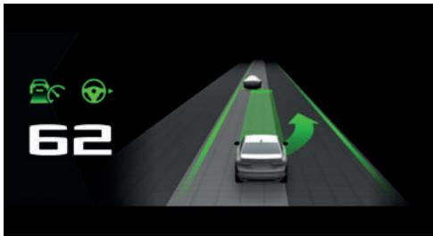
Пример с активной системой помощи водителю: контрольные и сигнальные лампы для системы контроля дистанции и ассистент смены полосы движения сигнализируют о смене полосы на соседнюю. Одновременно смена полосы движения на соседнюю отображается в анимированной форме в Assisted View.
