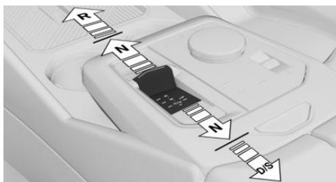
При пристегнутом ремне безопасности водителя нажмите или потяните рычаг селектора в нужном направлении, при необходимости с переходом за точку срабатывания. После отпускания рычаг селектора возвращается в среднее положение.
