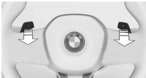
Подрулевые лепестки функции Boost Control находятся на рулевом колесе.
